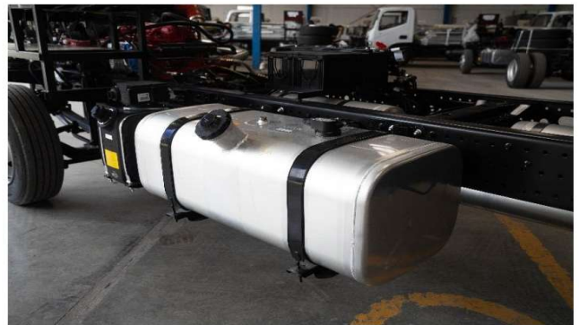
Tanques de Combustible 200 Litros
